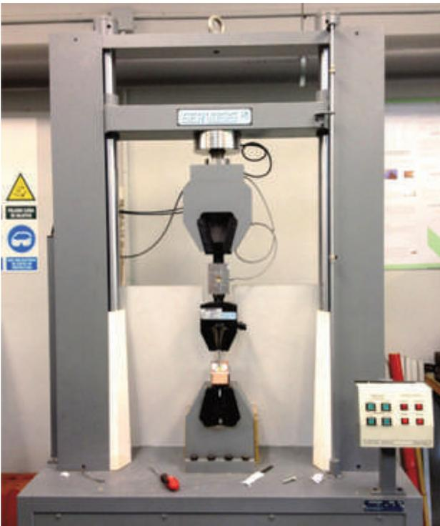
Figura 3. Máquina de ensayos dinámicos de materiales.
