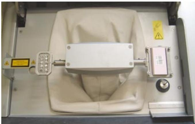
Figura 9: Marco de escaneado y fresado en el Cercon Brain.
