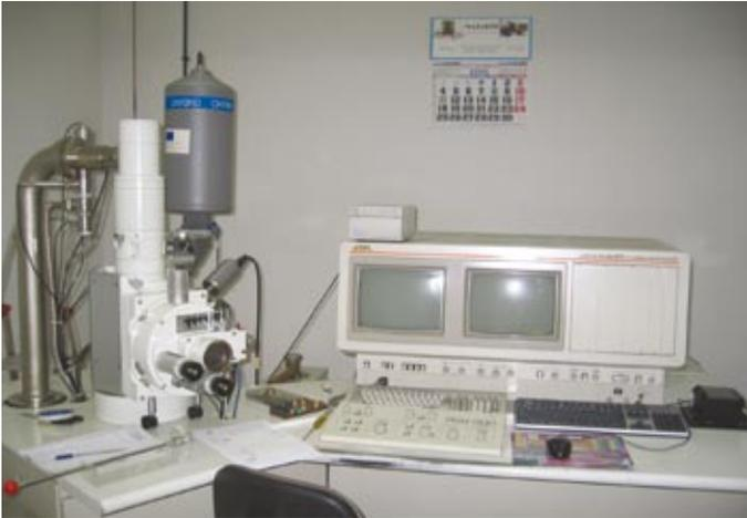
Figura 18: Microscopio electrónico de barrido.
