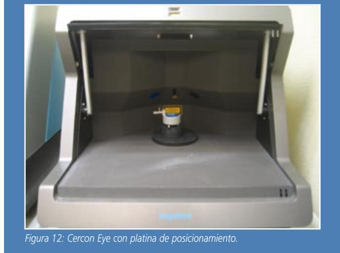
Figura 12: Cercon Eye con platina de posicionamiento.
